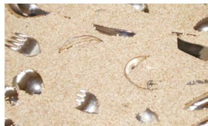
**2** Dort durchläuft es über einen spiralförmigen Aufstieg ein hochwertiges warmes Poliergranulat.
