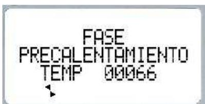
Pasado el control la máquina pasa a la fase de precalentamiento del granulado. Esta durará hasta que la placa calefactora alcance una temperatura aproximada de 80 grados centígrados.
