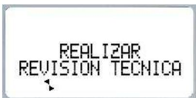
Pasadas 3000 horas de funcionamiento aparecerá el siguiente mensaje. Solo un técnico autorizado podrá volver a poner a 0 el contador. Hasta entonces la pantalla solo mostrará este mensaje.
